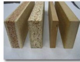
Spanplatte Sandwich, Spanplatte, mitteldichte Faserplatten (von links)
